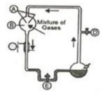
a) A – electrodes, B –  $(NH_3 + H_2 + H_2O +$
